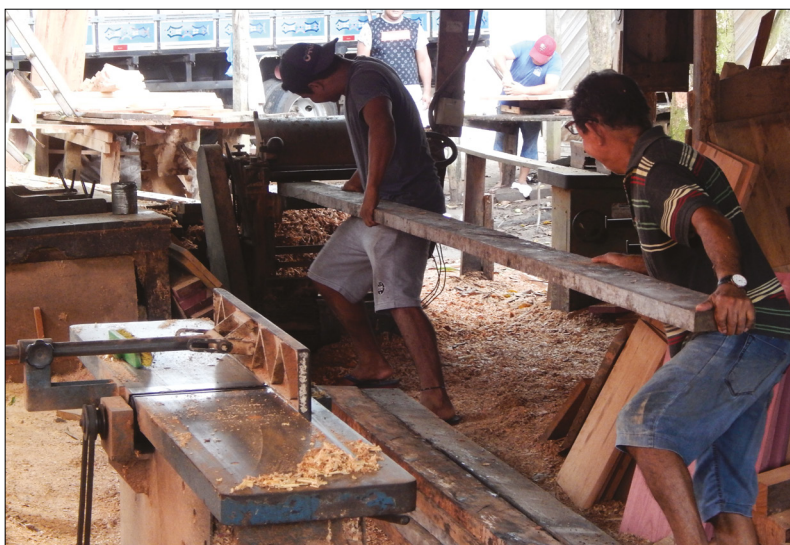
Figura 3 - Raimundo e Timóteo trabalham vigas na plaina desengrossadeira. Foto: Luiz Loureiro (2018).
